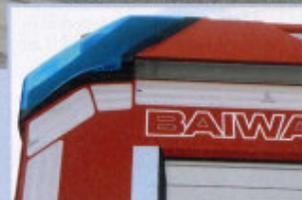
Eine Umfeldbeleuchtung ist in die überstehende Dachreling integriert. Sie besteht aus LED-Langleuchten. Hänsch-LED-Leuchten sind an den hinteren Ecken des Aufbaus unter einer BAIWAY-Design-Abdeckung eingebaut.
