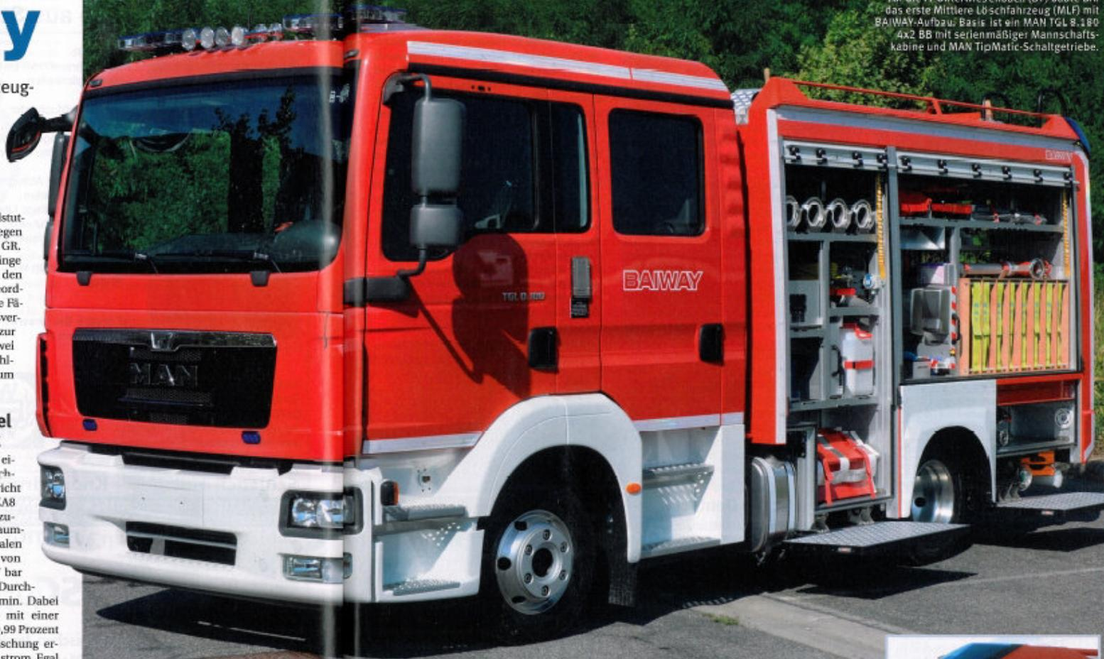
Für die FF Untere Wiesenubach (BY) baute BAI das erste Mittlere Löschfahrzeug (MLF) mit BAIWAY-Aufbau. Basis ist ein MAN TGL 8.180 4x2 BB mit serienmäßiger Mannschaftskabine und MAN TipMatic-Schaltgetriebe.
