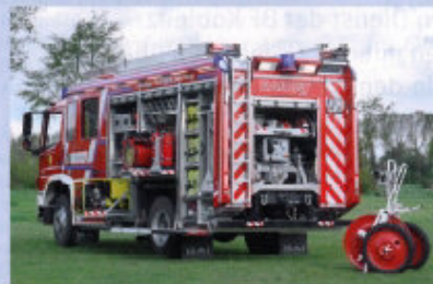
Am Heck kann eine Haspel für die Wasserversorgung aufgezupft werden.
