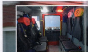
Für den Wehrführer gehören alle Atemschutzgeräte in die Mannschaftskabine. Daher stehen vier Geräte für Angriffs- und Wassertrupp zur Verfügung. Die Überzüge für die Kopfstützen hat er selbst genäht.
