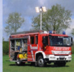
Auf dem Dach befinden sich ein Will Burt Lichtmast Nightscan mit sechs 900-Watt-Scheinwerfern, eine Steck- sowie eine Schiebelleiter.
