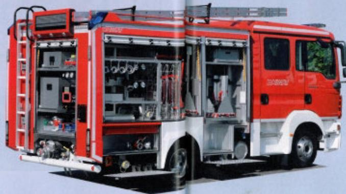
Fünf Geräteräume bieten Platz für die feuerwehrtechnische Beladung. Die Klappen unterhalb der Rollläden dienen auch als Aufritt. Der Aufbau ist – mit Ausnahme der Steckleiter – nicht höher als die Kabine.
