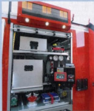
Die Bedieneinheit für Pumpe und Schaummittel-Druckmischanlage kann herausgeschwenkt werden. Ein blauer Koffer enthält Material zur Atemschutzüberwachung.
