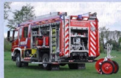
Bei der Pumpenbedienung ihres HLF 10 setzen die Hasenkruger Feuerwehrleute auf eine einfache Bedienung. Die vier B-Abgänge werden mit Niederschraubventilen, der Schnellangriff mittels Kugelventil geöffnet.
