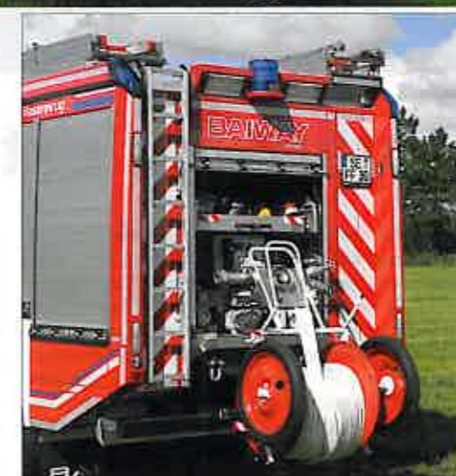
Arbeitsplatz: Zum Bedienen des Pumpenbedienstands am Heck muss die Schlauchhaspel weggeschwenkt werden.
