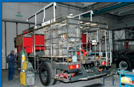
Export: Zu den BAI-Spezialitäten gehören Sonderlöschfahrzeuge aller Größenklassen, die je nach Einsatzzweck Aufbauten aus Edelstahl oder Aluminium erhalten und vielfach in den Nahen und Mittleren Osten exportiert werden.
