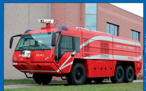
Flaggschiff: Das Flugplatzlöschfahrzeug „Poseidon“ (10.000 Liter Wasser, 1.200 Liter Schaummittel, Pumpenleistung 5.500 l/min bei 18,5 bar) auf MAN-6x6-Fahrgestell ist auf vielen italienischen Flughäfen anzutreffen.
