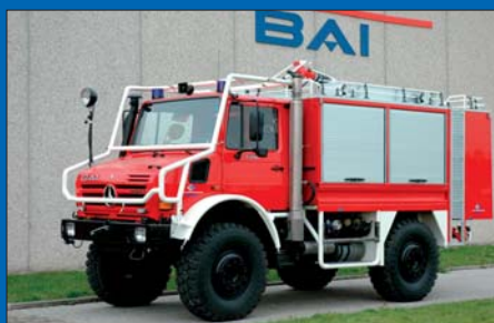
Robust: Für den Waldbrandereinsatz verfügt dieses Tanklöschfahrzeug auf Unimog U 5000 mit einem 3.000-Liter-Wasser- und einem 300-Liter-Schaummittelbehälter über eine Selbstschutzvorrichtung und eine 50-kN-Rotzler-Seilwinde.
