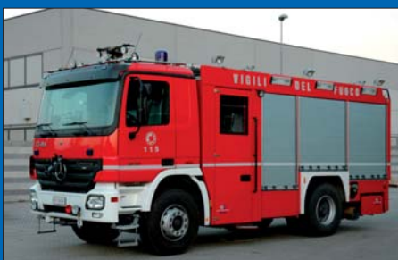
Bimodale: Für den Einsatz auf italienischen Bahnanlagen verfügt dieses Zweibegefahrzeuge auf Mercedes-Benz Actros 1832 mit der BAI-Bezeichnung „Bimodale“ eine Schienenfahreinrichtung des deutschen Herstellers Zagro.
