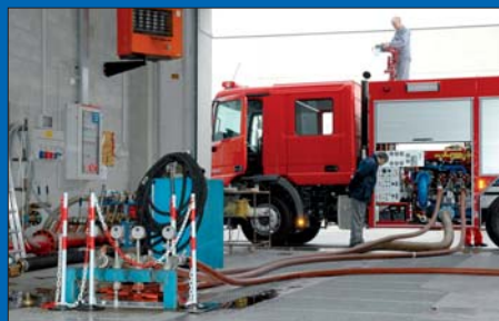
Kontrolle: Auf dem Prüfstand wird die Pumpe dieses Sonderlöschfahrzeugs getestet. Der Mercedes-Benz Actros 2650 verfügt über die speziell von BAI für DaimlerChrysler gefertigte Doppelkabine.
