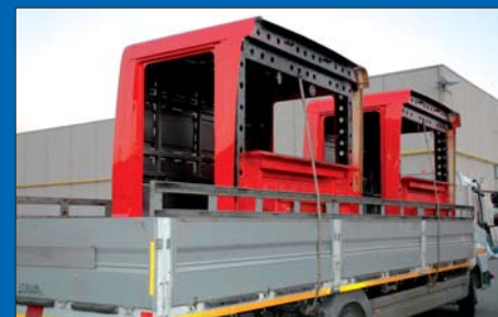
Von Haus zu Haus: Mannschaftskabinen fertigt BAI in einem nahegelegenen Zweigwerk. Sie werden dann mit einem eigenen LKW direkt in die Montagehalle geliefert.
